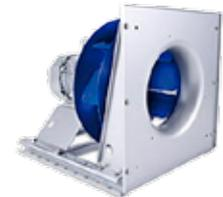
■ Motoren bürstenlosen ( für die EG- Plug-Lüfter ) oder Drehstrom-Asynchron -Käfigläuferwicklung und Klasse F. Alle Motoren mit der Effizienzklasse IE2 ( IE3 auf Anfrage) nach der internationalen Norm IEC 60034-30 und der ErP-Richtlinie 2009/125/EG (früher EuP) .
