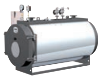
PREX N ASL 1.000 - 3.500 kW Caldaia per acqua surriscaldata fino a 145°, a tre giri di fumo di cui due in camera di combustione.
