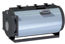
RSW N ★★ RSH ★★ 2360 - 6000 kW / 1850 - 3000 kW Caldaia per acqua calda a tre giri di fumo di cui due in camera di combustione
