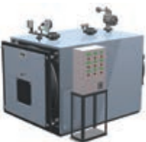
PREX Q ASL 160 - 1.740 kW Caldaia per acqua surriscaldata fino a 145°, a tre giri di fumo di cui due in camera di combustione.
