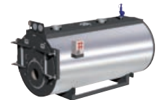
PREXTHERM T3G N ASL PREXTHERM T3G N ASH 6.000 - 15.000 kW Caldaia per acqua surriscaldata, a tre giri effettivi di fumo.
